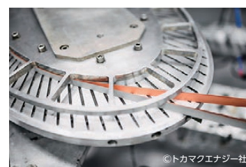
ST-80 マグネットコイルの製造
